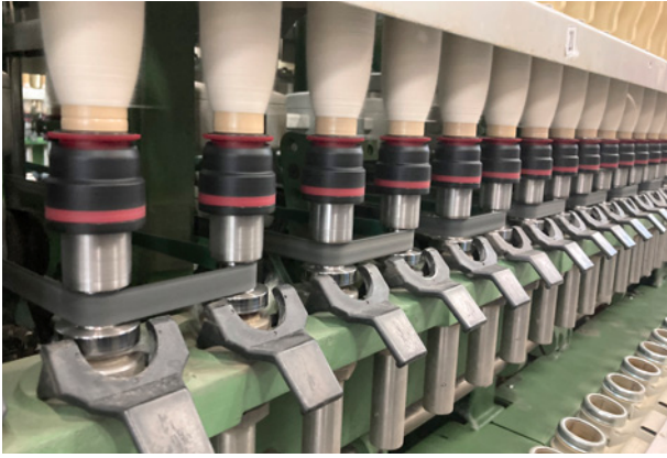
NASA HPS 68锭子和CROCOdoff夹纱器是实现全新性能水平的完美组合。
